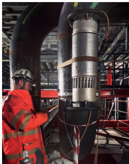
Bilde: Min tidligere kollega Ben Miller. Røntgenjobb i en pipe rack på et kraftverk i Finland. Foto: LKJ
