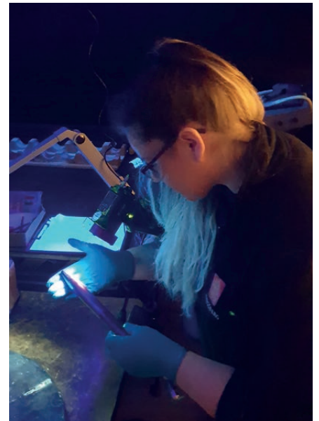
Bilde: Fluoriserende penetrant inspeksjon (FPI) av pitotrør til Sea King.
